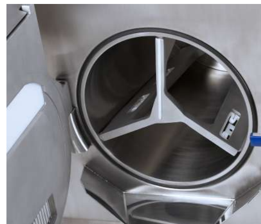
KEO-Rührwerk, größte Füllöffnung und monolythischer Kessel Aufbau
