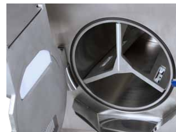
KEO-Rührwerk, größte Füllöffnung und monolithischer Kessel Aufbau
